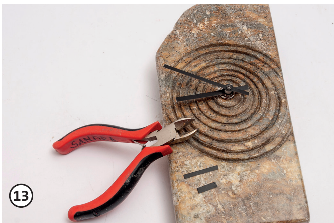
13 Mit dem Seitenschneider Zeiger kürzen. Zeiger auf das Gewinde stecken. Zum Abschluss Abdeckkappe auf das Gewinde drücken.
