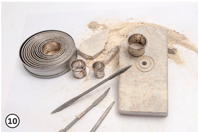
10 Auf der Vorderseite des Specksteins, um die Bohrung, Kreise aufzeichnen. Mit einem Stechbeitel Kreis-Rillen stechen, zuletzt mit Schleifpapier bearbeiten.
